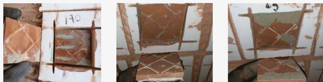
SUBSTRATO DE CONCRETO ARMADO SUBSTRATO DE BLOCO DE CONCRETO SUBSTRATO DE REVESTIMENTO CIMENTÍCIO
