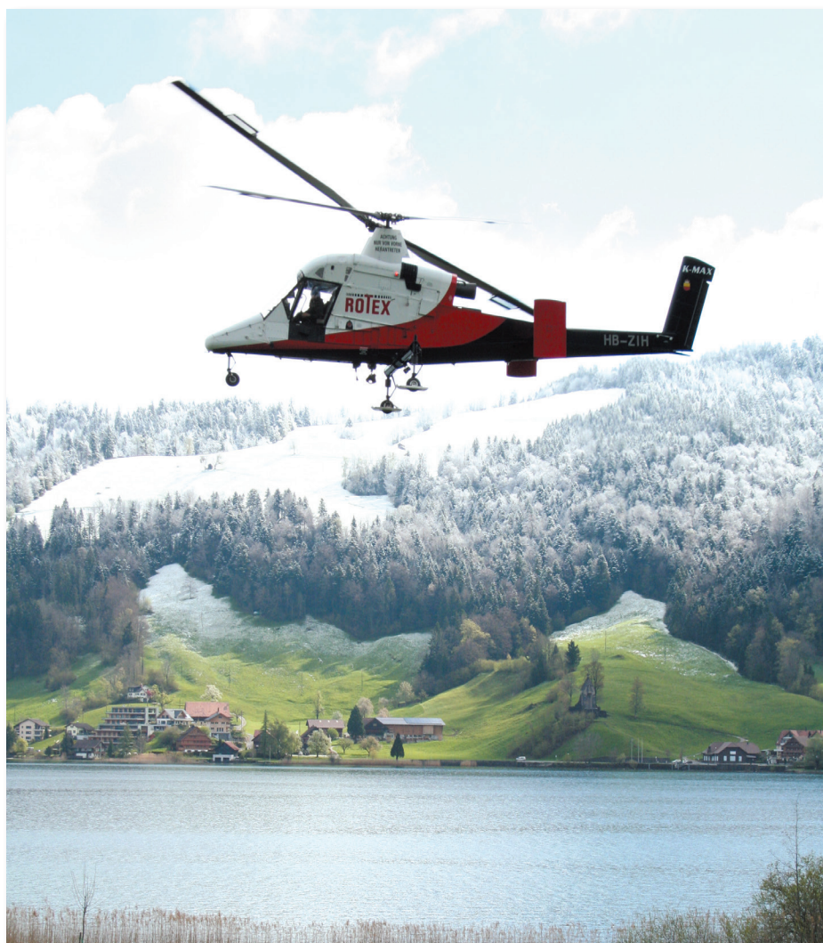
«Kaman K-Max K-1200»: dank Leichtbauweise und zwei Rotoren 2'722 kg Nutzlast bei nur 2'300 kg Eigengewicht ( www.rotex-helicopter.ch ).
