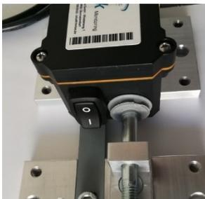
Mittels den im Sensorsystem integrierten Wippschalter wird der Funkknoten aktiviert. Die Verbindung zum Gateway wird anschließend selbständig aufgebaut.
