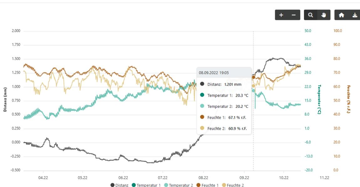
An den Y-Achsen werden die verschiedenen Werteskalen (Distanz, Temperatur, Feuchte) dargestellt. Die X-Achse stellt die Zeitachse dar.
