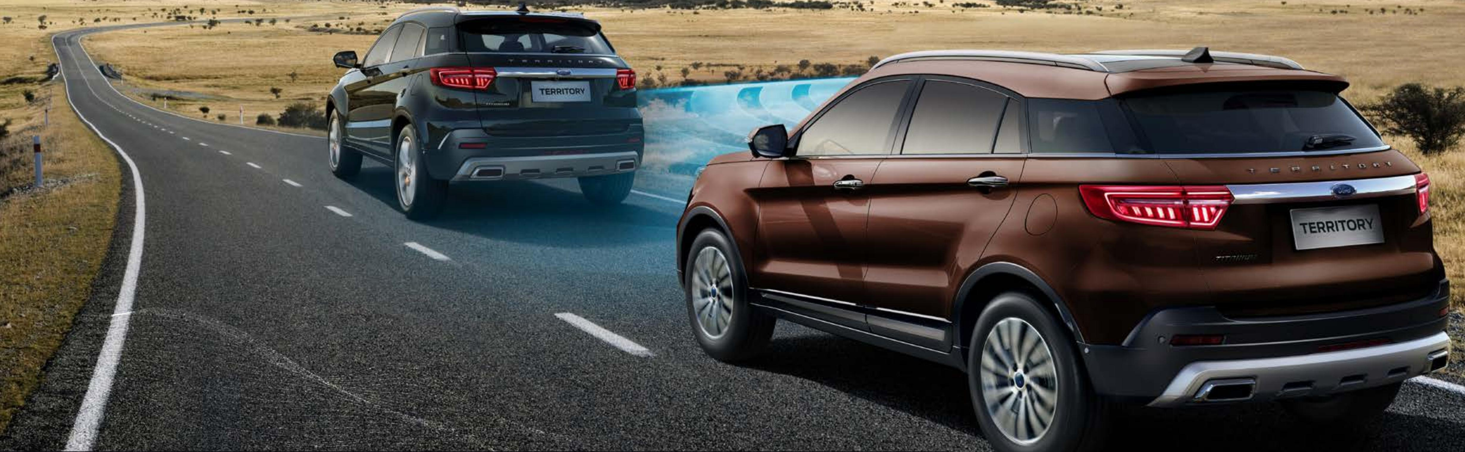
Regula automáticamente la velocidad del vehículo, de manera tal de mantener constante la distancia con el vehículo de adelante. Dicha distancia es regulable por el conductor. Si el vehículo de adelante se detiene, el sistema Stop & Go detendrá al vehículo y volverá a avanzar cuando el vehículo de enfrente avance, volviendo a los parámetros de distancia y velocidad configurados.
