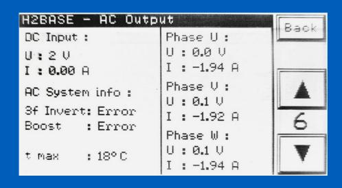
Detail of AC output parameters
