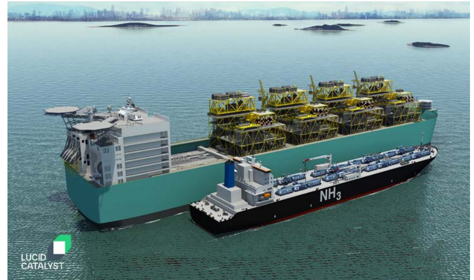
그림 9. 조선소에서 제작한 해상 암모니아 생산플랫폼
