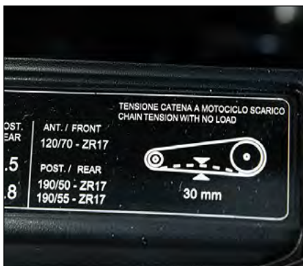
Zo test je de kettingspanning van deze Aprilia.
