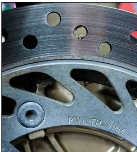
Deze remschijf moet minimaal 4 mm dik zijn.
