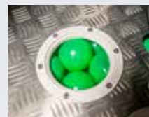
► Flytmaterialet i Tärnskär består av plastbollar, liknande dem i bollhav för barn.
