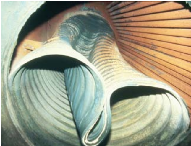
Foto 1: Ingezakte en gescheurde vuurgang als gevolg van een falende laagwaterbeveiliging.
