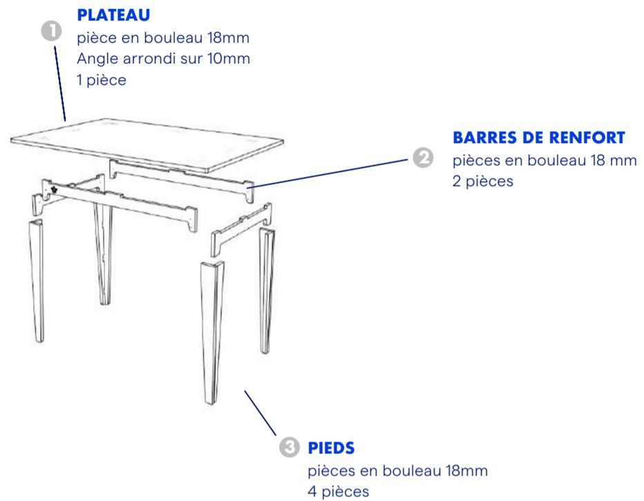
+ **VISSERIE** : vis autoforantes pour garantir la rigidité de l'assemblage
