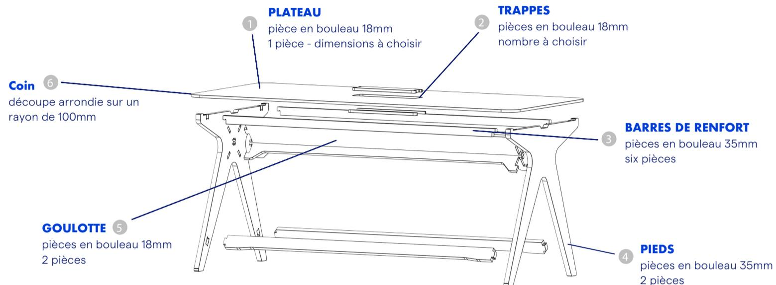
+ VISSERIE : vis autoforantes pour garantir la rigidité de l'assemblage
