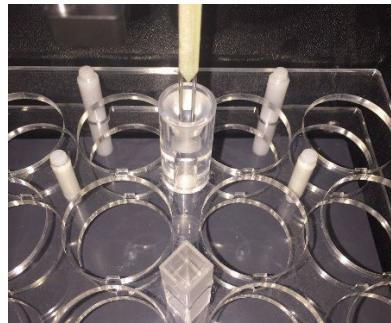
Após alinhar o copo de lavagem e clicar/tocar em Próxima etapa, o instrumento vai calibrar automaticamente a posição do eixo Z da sonda até o fundo o copo de lavagem. (O eixo vai se mover para cima e para baixo, e a luz vermelha vai acender e apagar).
