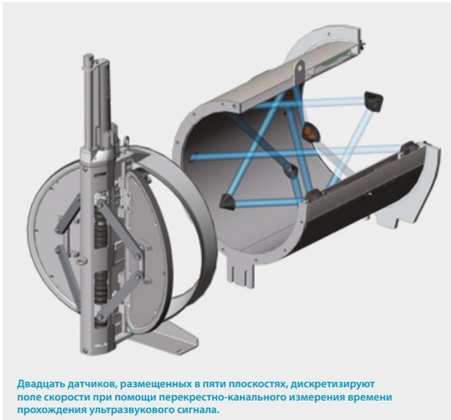
Двадцать датчиков, размещенных в пяти плоскостях, дискретизируют поле скорости при помощи перекрестно-канального измерения времени прохождения ультразвукового сигнала.
