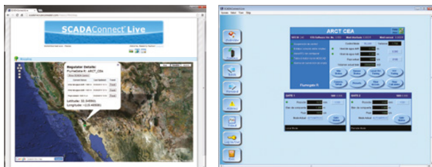
Экраны ПО «SCADAConnect», используемые для управления головными затворами ARCT
