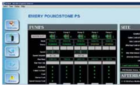
Il software NeuroFlo controlla la portata delle pompe ed aziona i FlumeGates per mantenere livelli stabili di acqua a valle
