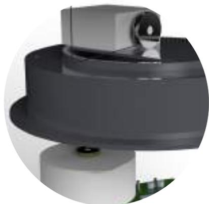
Il movimento del corpo è consentito attraverso un filo collegato ad un motore passo passo per comprimere o rilasciare le "vertebre".
