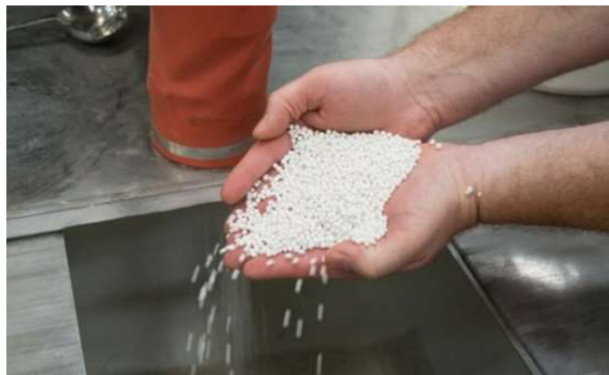
PHA（ポリヒドロキシアルカン酸） 自然環境中で分解する繊維
