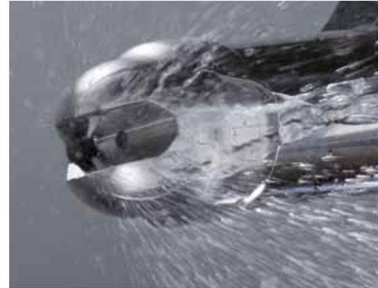
Limpieza por pulverización del OPTISENS OAS 2000, sensor de sólidos suspendidos
