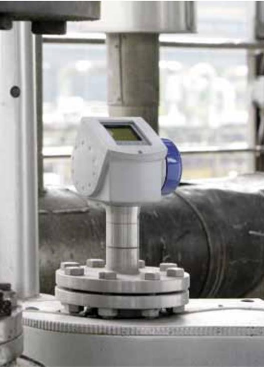
El radar de onda continua y frecuencia modulada (FMCW) emite una señal de alta frecuencia que es reflejada por la superficie del producto y recibida de vuelta. Estos medidores permiten una medida de nivel continua y sin contacto de líquidos, pastas, granulados, polvos y otros sólidos para una amplia gama de industrias:
