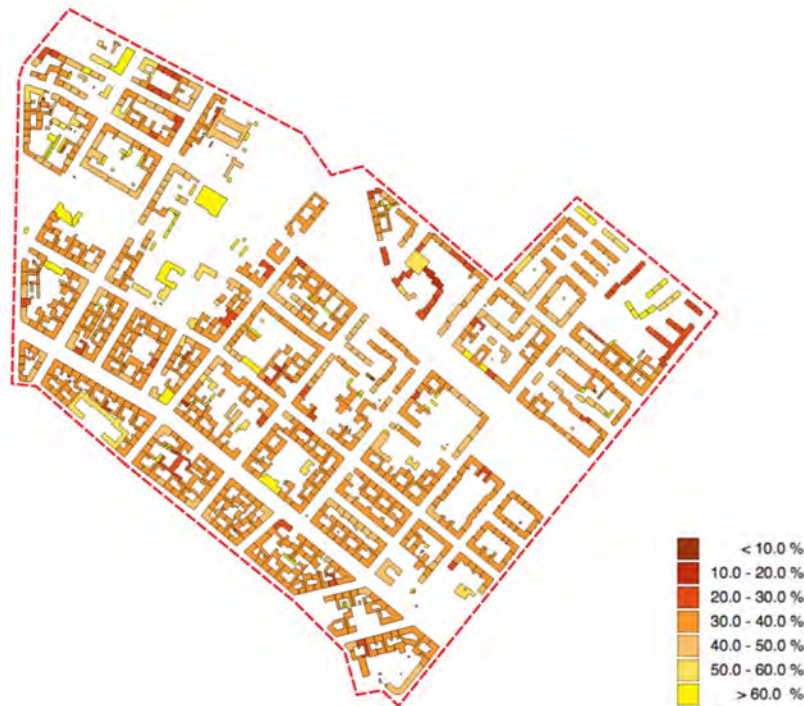
Abbildung 6.5: Mit Open eQuarter MOLE berechnete erreichbare solare Deckungsrate je Gebäude bei flächendeckender Nutzung von Solarthermie (VPT 2015)
