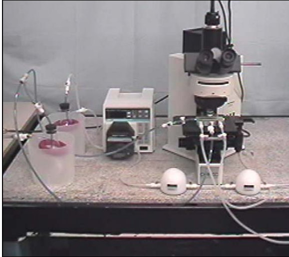
図 2. フローシステムセットアップの様子(左から右へ): 各々プラスチック容器に入った真空ピン、細胞培養メデュームビン、ペリスタルティックポンプ、液体パルスダンパー 1、顕微鏡台にセットされたFlexFlow™、液体パルスダンパー 2。
