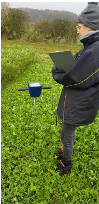
Abbildung 13: Erhebung der Bodenfeuchte mittels AgroFlow am 26.11.2020
