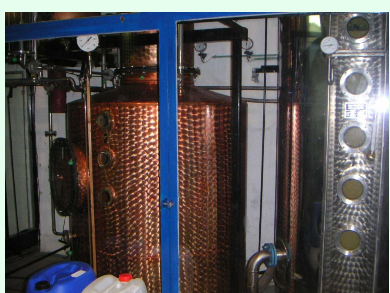
Destillierapparate (Raubrand und Feinbrand)
