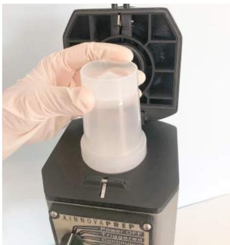
**FIGURE 4.16** SAMPLE CUP SNAPPED INTO THE FILTER
