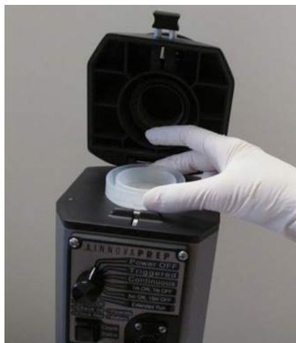
**FIGURE 4.12** INSTALLING FILTER CASSETTE
