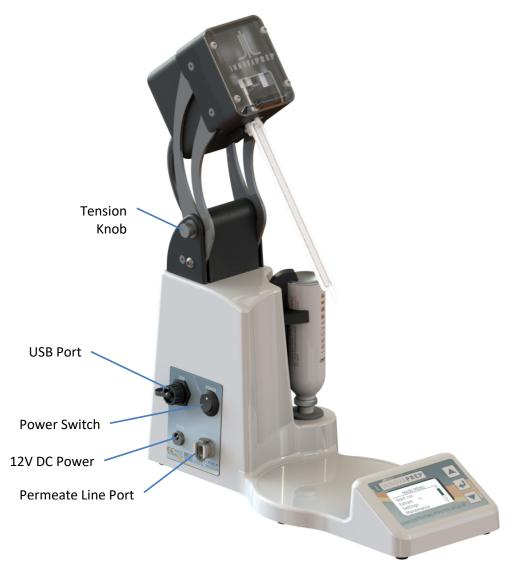
FIGURE 3.2 INSTRUMENT COMPONENTS – LEFT SIDE
