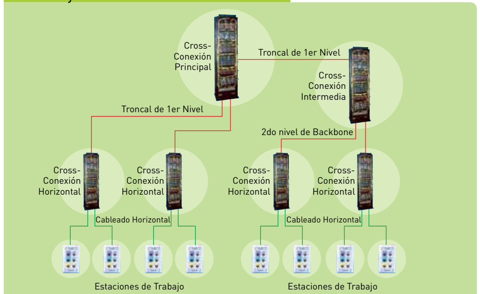
Figura 1: Estructura del Cableado Troncal y Horizontal
