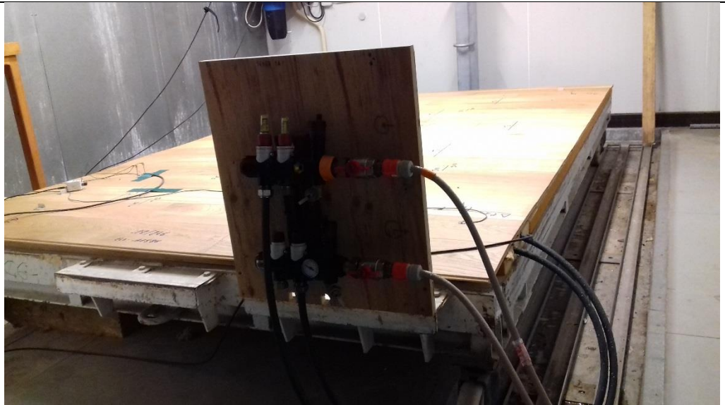
Systeme sol chauffant rafraichissant Freeheat avec parquet et systemes de capteurs en chambre humide
